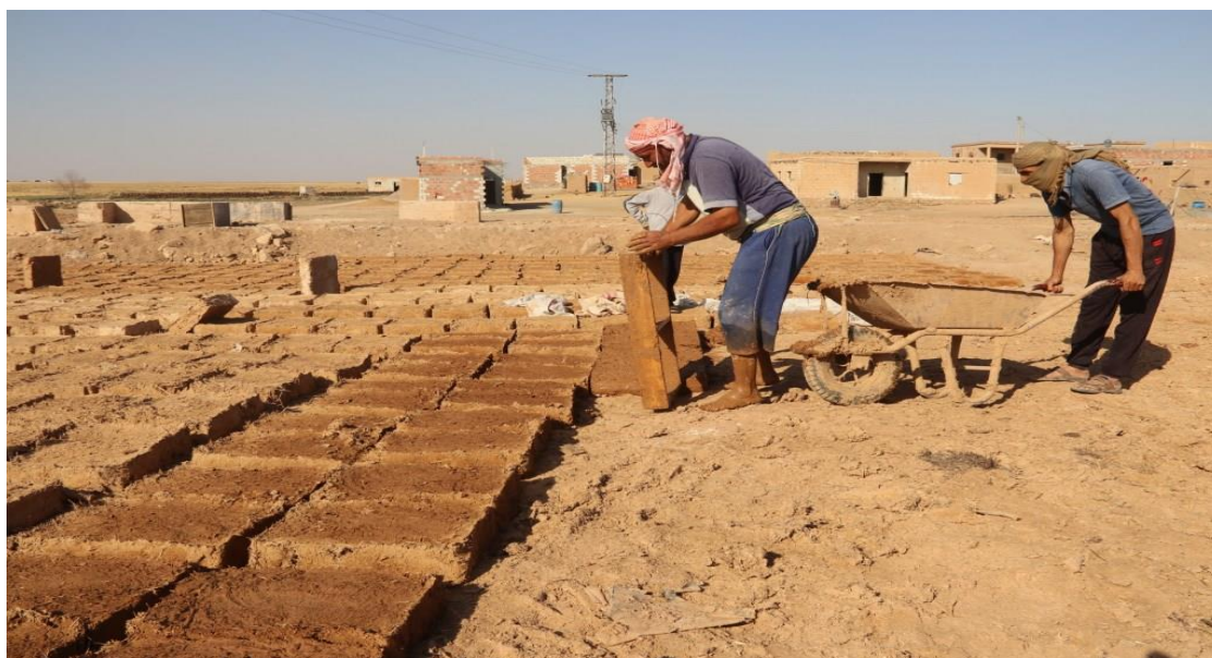
Los ladrillos Kelbiç utilizados para la construcción de la escuela de Umceren están hechos de barro y paja y luego se ponen a secar al sol.
